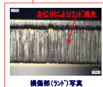
損傷部(ランド)写真
